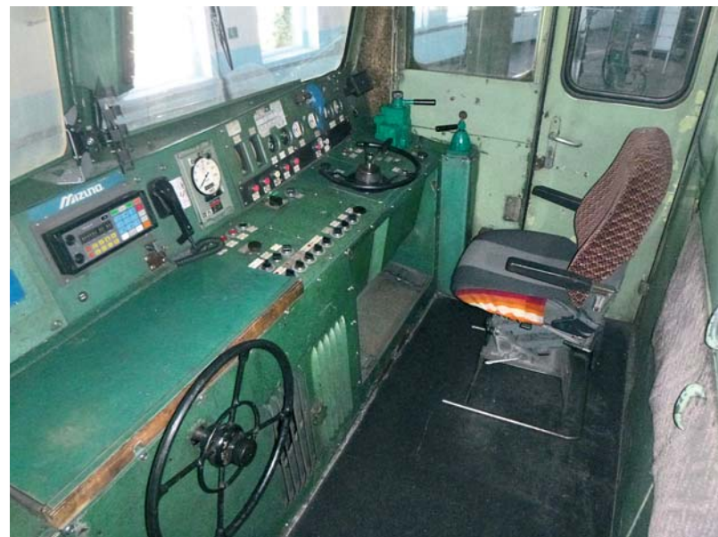
Stanoviště strojvedoucího na lokomotivě řady 749
