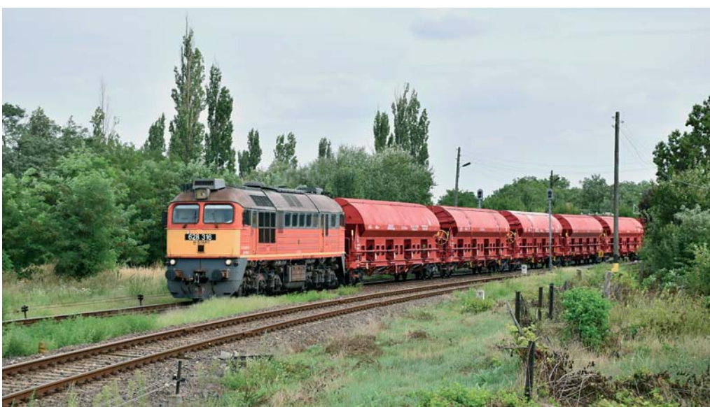
„Sergej“ M62.316 je zástupce modernizované řady se sériově dosazovanými motory značky MTU zachycený s nákladním vlakem ve stanici Borgond. Foto: Michal Roh ml.
