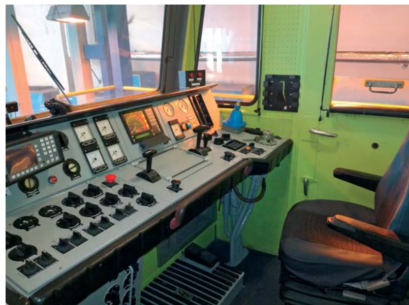
Stanoviště strojvedoucího na lokomotivě řady 163
