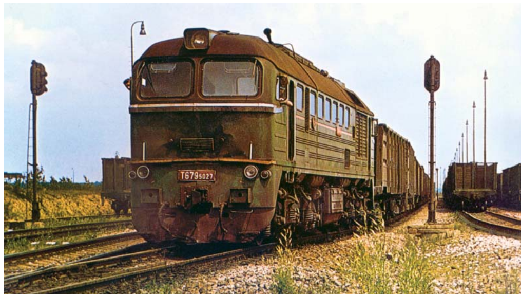
Jeden ze zástupců širokorozchodných „sergejů“ – stroj T 679.5027. Číslo lokomotivy prozrazuje, že se jedná o jeden ze dvou strojů, dodaných mimo ČSD, v tomto případě pro elektrárnu Vojany. Sběrka: Jiří Maurenz
