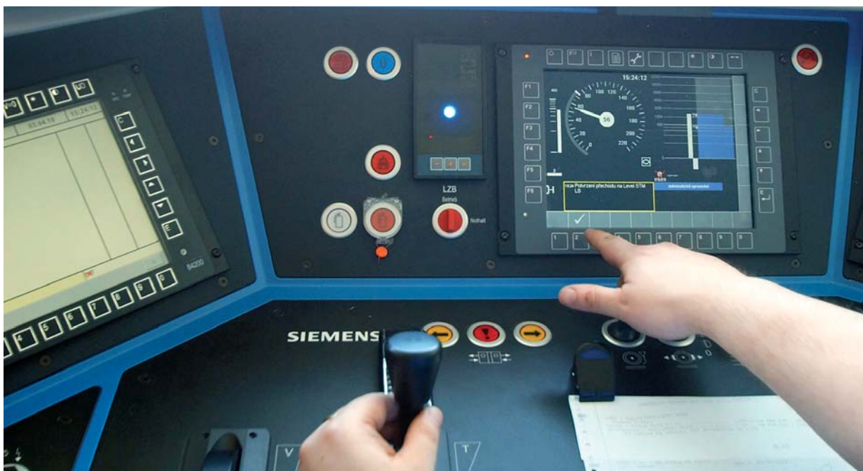
Demonstrace potvrzení resp. vzetí na vědomí strojvedoucím, že přechází pod dohled národního zabezpečovače.
