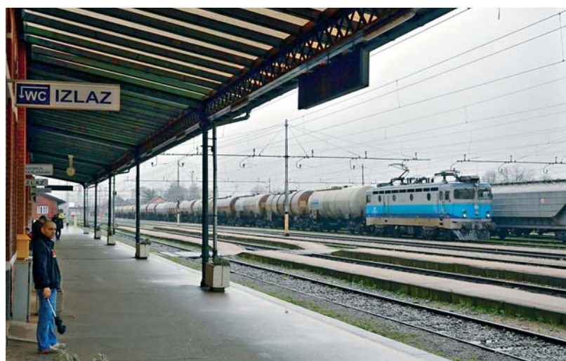
Cisternový vlak s lokomotivou Asea HŽ Cargo ve stanici Karlovac 27. března 2015. Na snímku je dobře patrné původní trakční vedení pro 3 kV ss, poměrně jednoduše upravené pro střídavý systém. Foto: Martin Šarman
