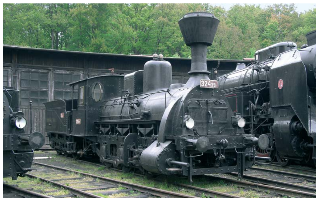
Vnější rám je dobře viditelný na lokomotivě 324.391. Vně rámu je pouze pohon lokomotivy (ojnice a spojnice), kola a rozvod páry jsou umístěny uvnitř rámu.
