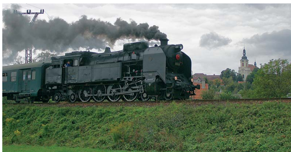
Usměrňovací plechy na přední části kotle některých lokomotiv zajišťují zvedání rozráženého vzduchu nad lokomotivu, který odnáší kouř z komína při jízdě bez páry, aby nepřekážel lokomotivní četě ve výhledu. Lokomotivy řady 464.0/1 kvůli velikosti těchto plechů dostaly přezdívku „ušatá“.
