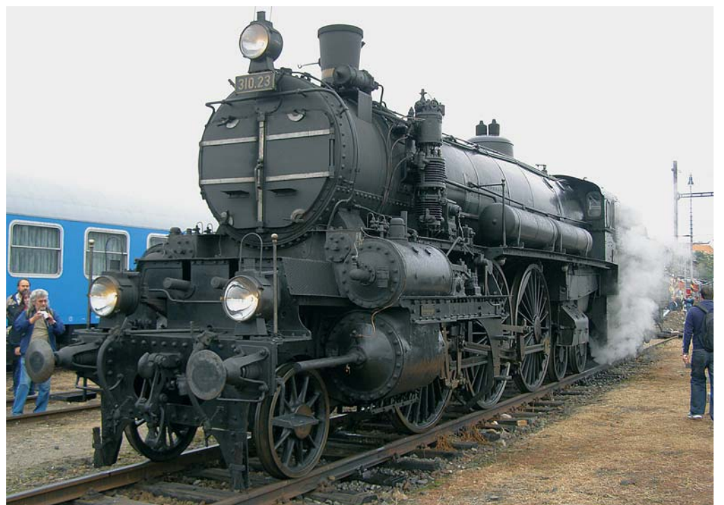
Kompresor na výrobu stlačeného vzduchu má rakouská parní lokomotiva 310.23 (československá řada 375.0) jako ostatní lokomotivy vpředu vlevo na straně topiče. Na této lokomotivě je patrný i generátor na výrobu elektřiny vlevo od komína a velká čelní lucerna.
