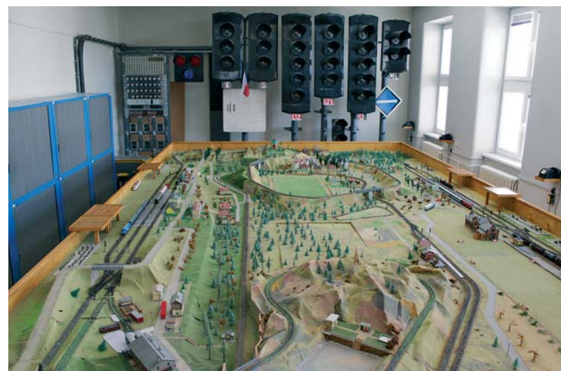
Dopravní sál s modelovým kolejištěm a zabezpečovacím zařízením
