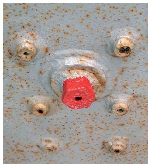
Dutý šroub vyplněný olovem je poslední pojistka před poškozením topeniště při poklesu vody v kotli.
