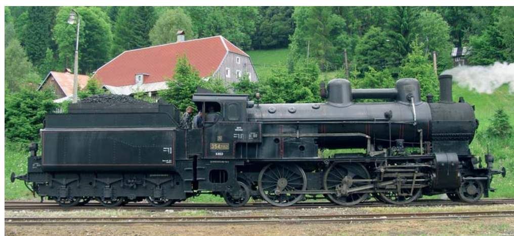
Klasický pohled na lokomotivu s vnitřním rámem. Rám je „schován“ za kola pod kotlem a pro obdivovatele je k dispozici celý pohon i rozvod lokomotivy, jak jsme to mohli vidět na lokomotivě 354.7152 při oslavách jejich 100. narozenin v Kořenově.
