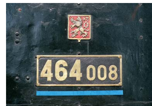
Podtržení řady a čísla lokomotivy na strojvůdcovské budce bleděmodrým pruhem oznamuje ocelový materiál topeniště a vyzývá topiče k citlivější obsluze.
