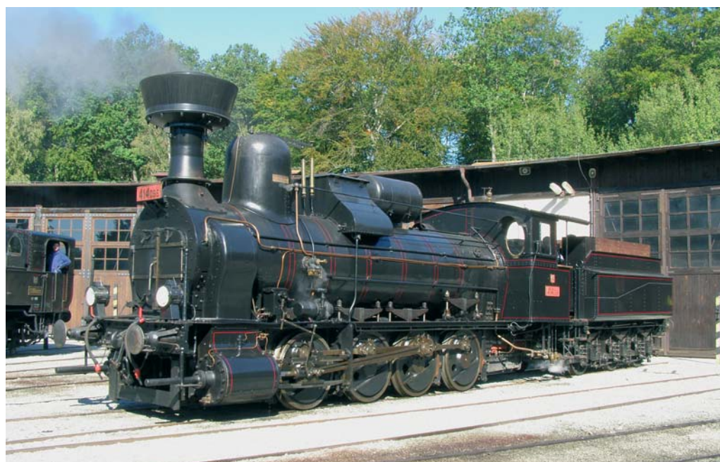
U lokomotivy 414.096 opětovně zprovozněné po mnoha letech postrádáme na kolech obvyklé tyčové rozvodu páry, protože je skryto uvnitř rámu lokomotivy.
