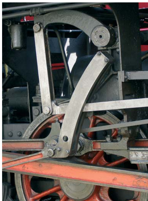
Kulisa – ve své době výrobně velmi náročná součást rozvodu páry, která slouží k požadovanému nastavení plnění válců parou.
