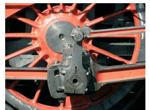
Protiklika zajišťuje hlavní pohyb šoupátek pro rozdělování páry před píst a za píst. Je nasazena na hnacím čepu, spolu s ojnicí. Pokud má lokomotiva tři válce, pohyb šoupátek třetího válce se odvozuje od protikliky na dalším spřaženém dvojkolí.
