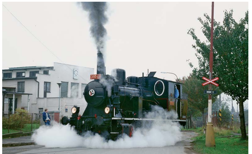
Typické zahalení lokomotivy do páry při rozjetu, kdy je nutno otevřít odvodňovací kohouty na spodní straně válců, aby zkondenzovaná voda nepoškodila víka válců.
