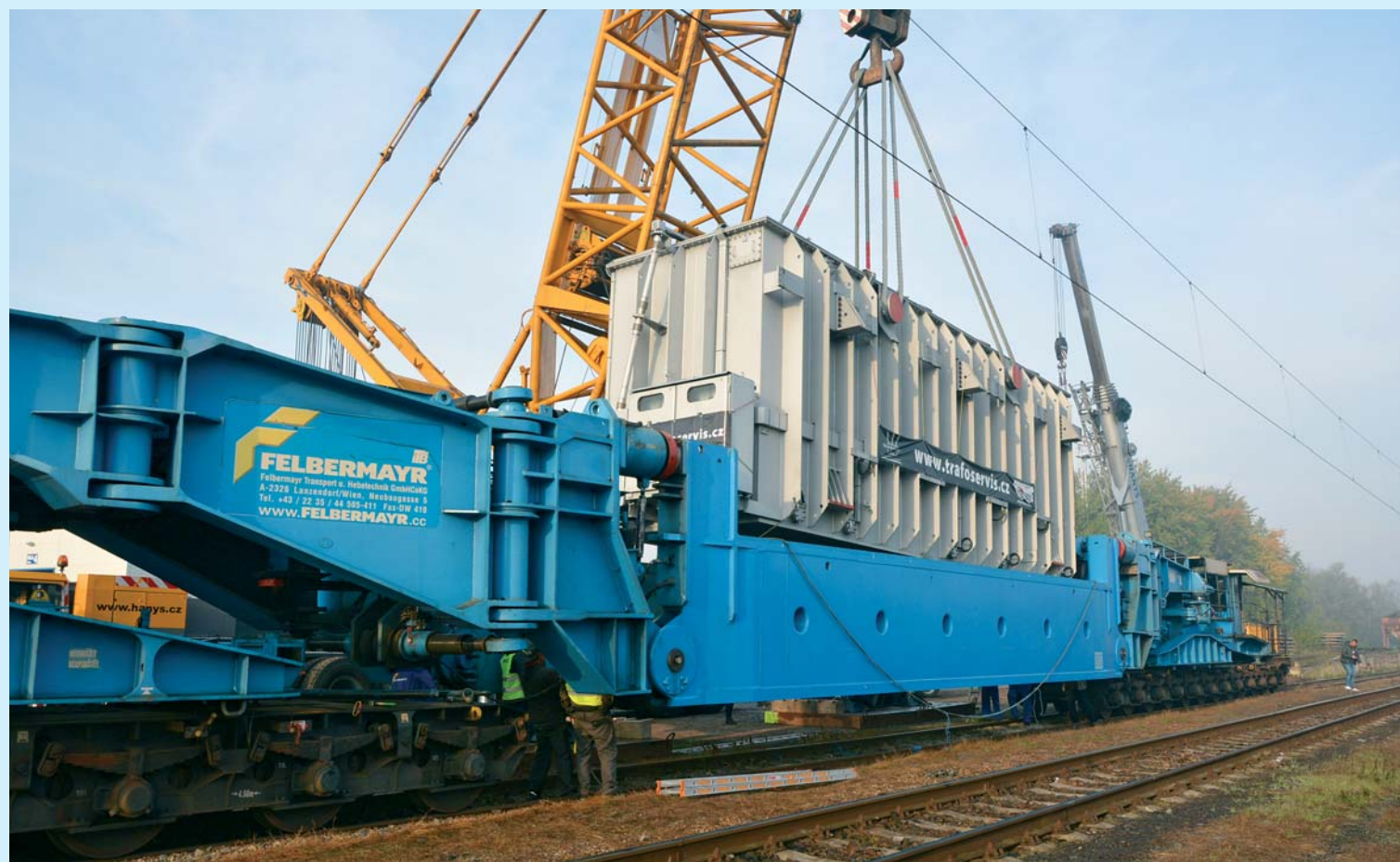
Nakládku transformátoru v Chlumci nad Cidlinou
