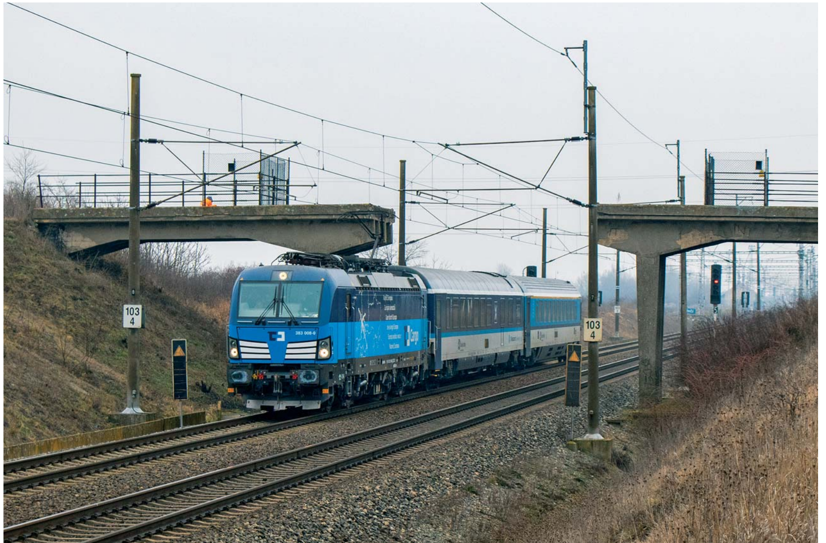
Vectron 383.008 naší společnosti byl hlavním hrdinou testovací jízdy na rychlost 200 km/hod, která se uskutečnila v pondělí 13. ledna 2020 v úseku Břeclav – Brno. Jízda byla součástí testů a měření s cílem ověřit, zda v tomto tratovém úseku dávají úpravy na vyšší rychlost smysl a co vše je potřeba změřit. Zkušební provoz povolil Správe železnic Dražní úřad. Dalibor Palko zachytil testovací vlak u stanice Zaječí.
