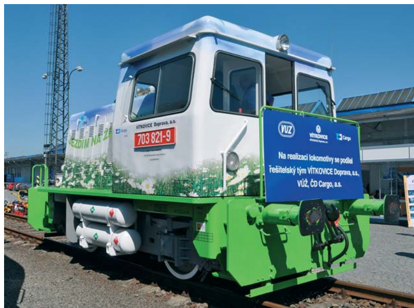
Lokomotiva 703.821 byla přestavěna na pohon zemním plynem.
