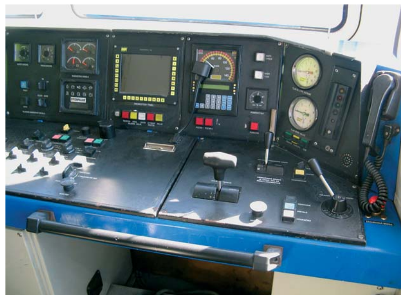
Stanoviště strojvedoucího na lokomotivě řady 755
