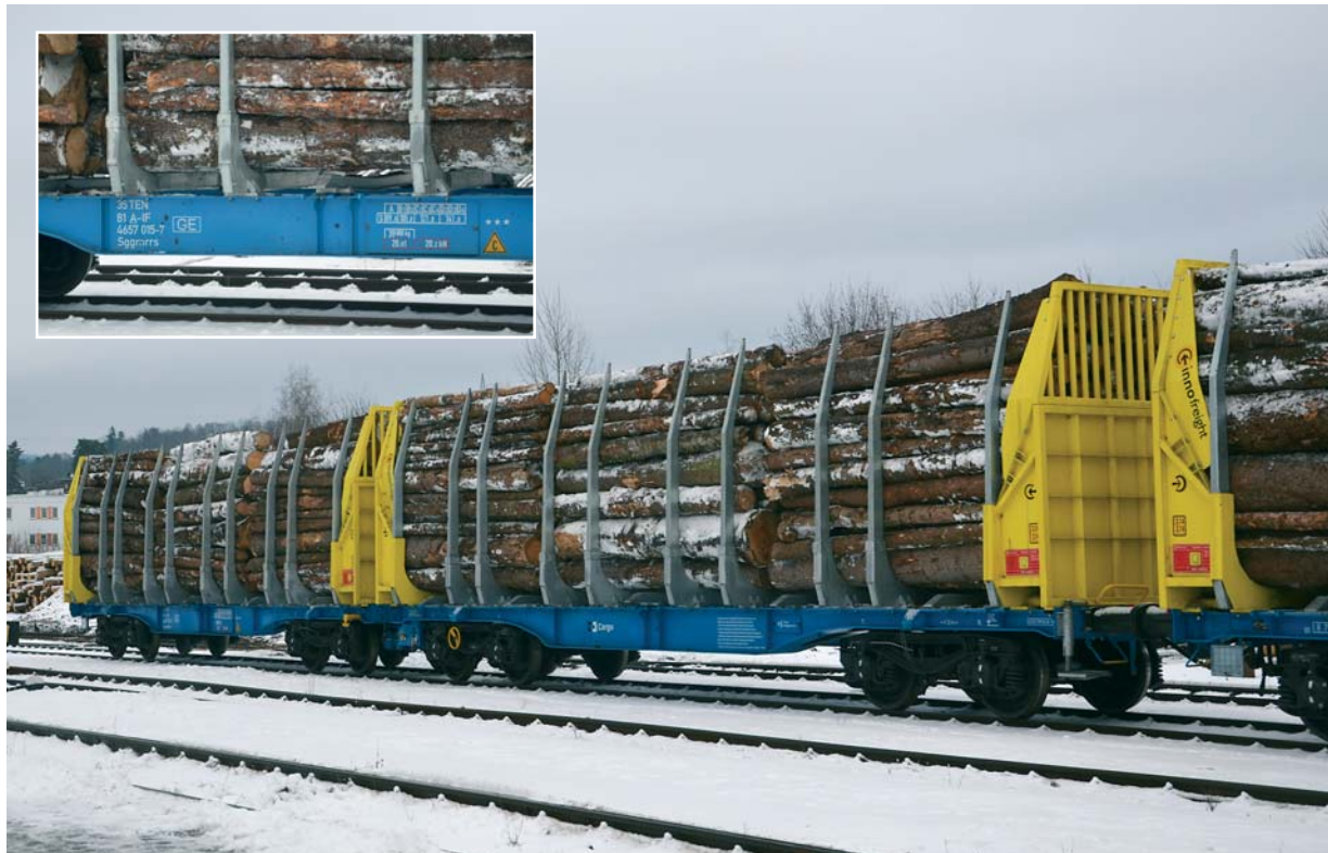
Nástavby GigaWood na vozech řady Sggmrrs po nakládce ve stanici Vrchlabí
