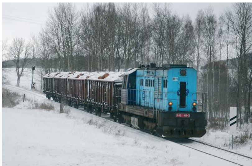
Nástavby GigaWood na vozech řady Sggmrrs po nakládce ve stanici Vrchlabí
