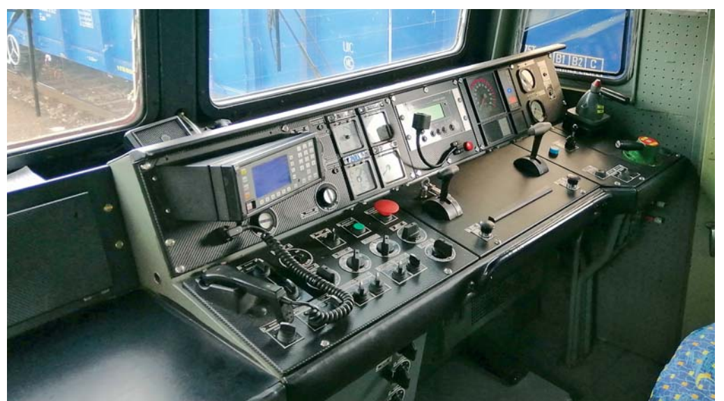
Stanoviště strojvedoucího na modernizované lokomotivě řady 131 Foto: Jiří Kluz
