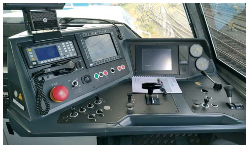
Stanoviště strojvedoucího lokomotivy řady 744.1
