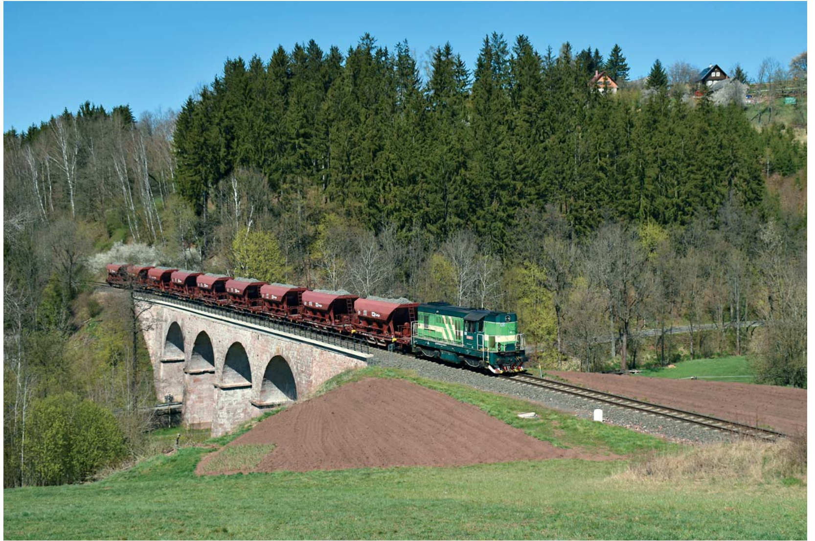
Po viaduktu v Bělé u Staré Paky projíždí manipulační vlak Mn 84109, jehož zátěž tvořilo 20. dubna 2020 devět výsypných vozů řady Faccs z lomu v Košťalově. Část vozů se štěrku mířila na výluky probíhající koncem dubna na Trutnovsku. Více informací o roli ČD Cargo při výlukách se můžete dozvědět uvnitř magazínu.
