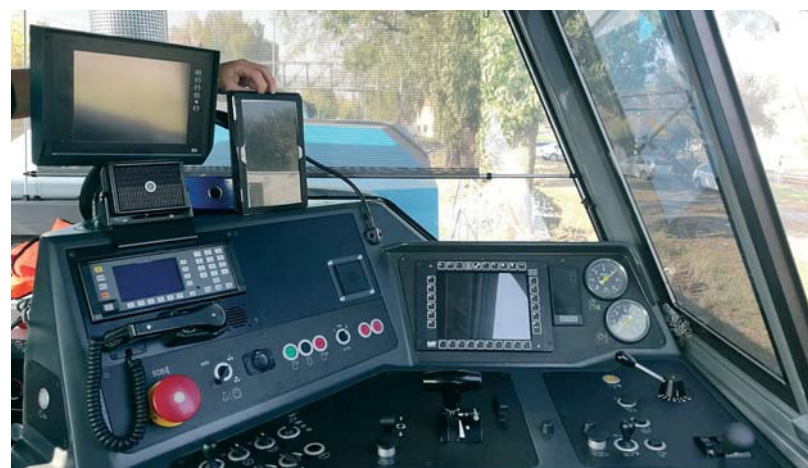
Stanoviště strojvedoucího lokomotivy řady 742.71
