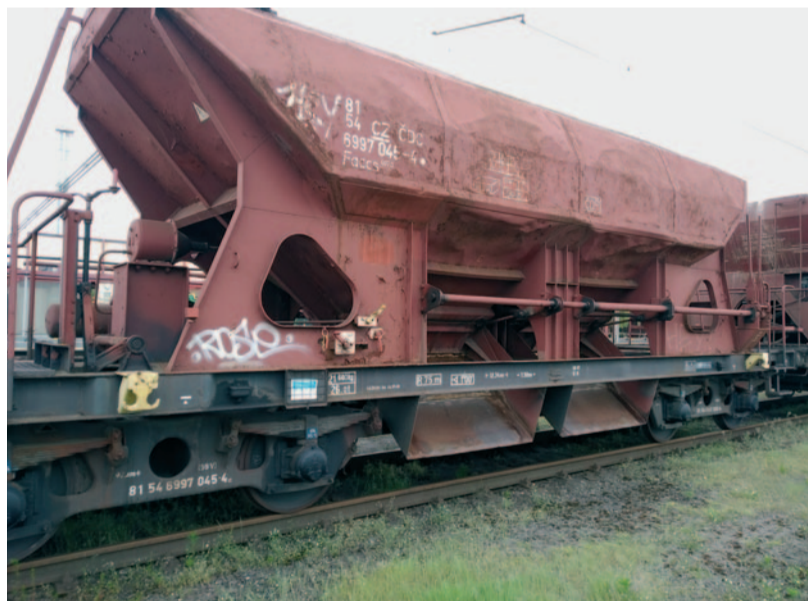
Vůz řady Fassc ve stavu před modernizací...
