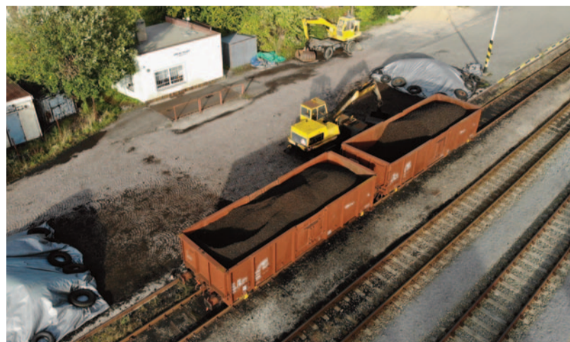
Dvounápravové vozy řady Es jsou k přepravě tříděného uhlí používány dodnes.
