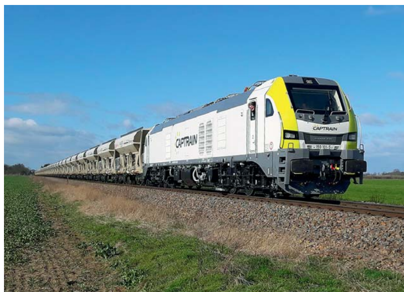
Lokomotiva EURODUAL v kombinaci pro provoz na neelektrizovaných a elektrizovaných tratích střídavých proudových soustav 15 kV a 25 kV je u dopravce Captrain v běžném provozu. Sbírka: Petr Kadeřávek
