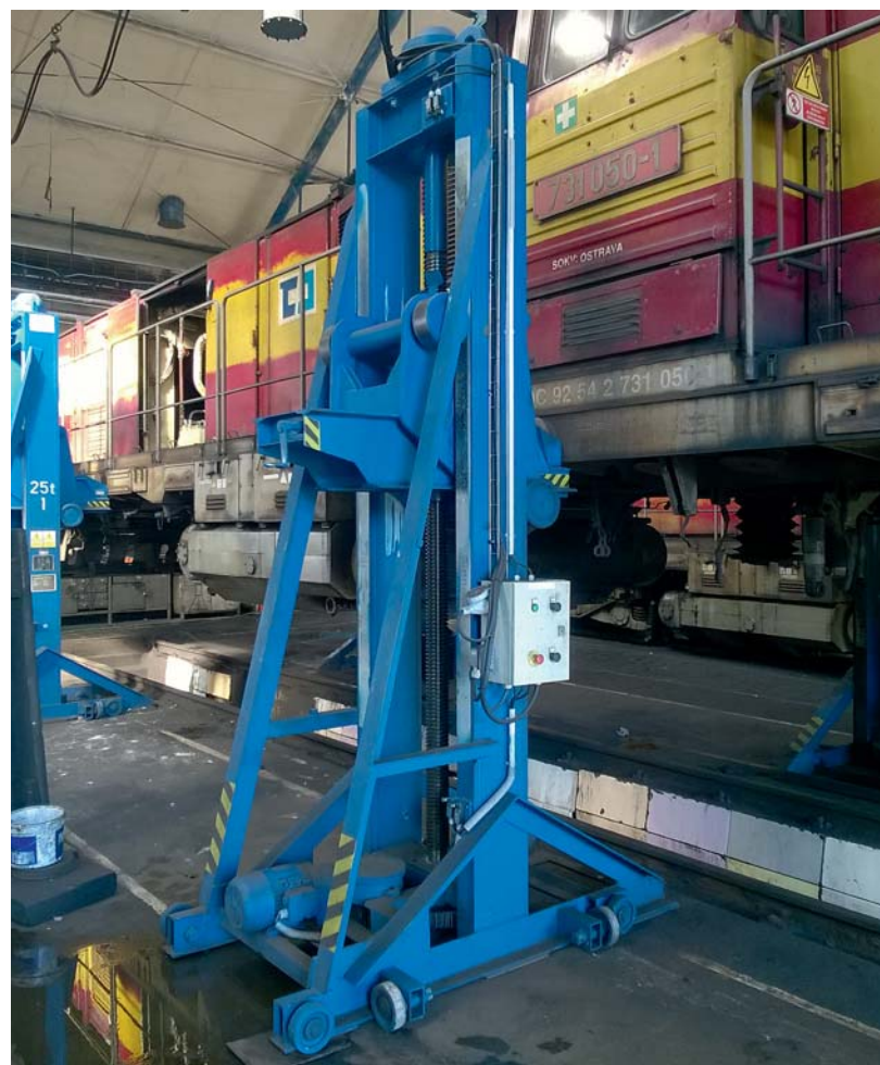
Zvedáky v SOKV Ostrava po rekonstrukci
