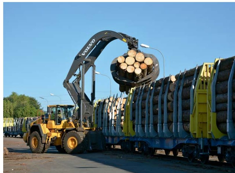
Vykládka velkokapacitních nástavb GigaWood na pile v Retzu
