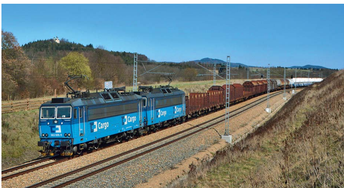
Dvousystémové lokomotivy řad 363 a 363.5 jsou nosnými stroji při zajišťování vozby mezi Prahou a Plzní a Prahou a Českými Budějovicemi.
