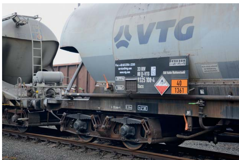
Přeprava uhelného multiprachu je realizována ve speciálních vozech v souladu s Řádem pro mezinárodní železniční přepravu nebezpečných věcí.
