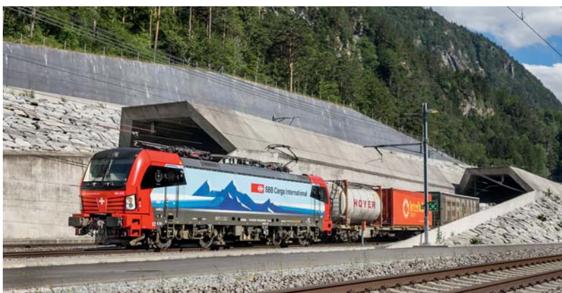
Vectron 193.476 společnosti SBB Cargo International opouští Gotthardský úpatní tunel u Erstfeldu a s intermodálním vlakem z Itálie míří k severu do Rotterdamu.
