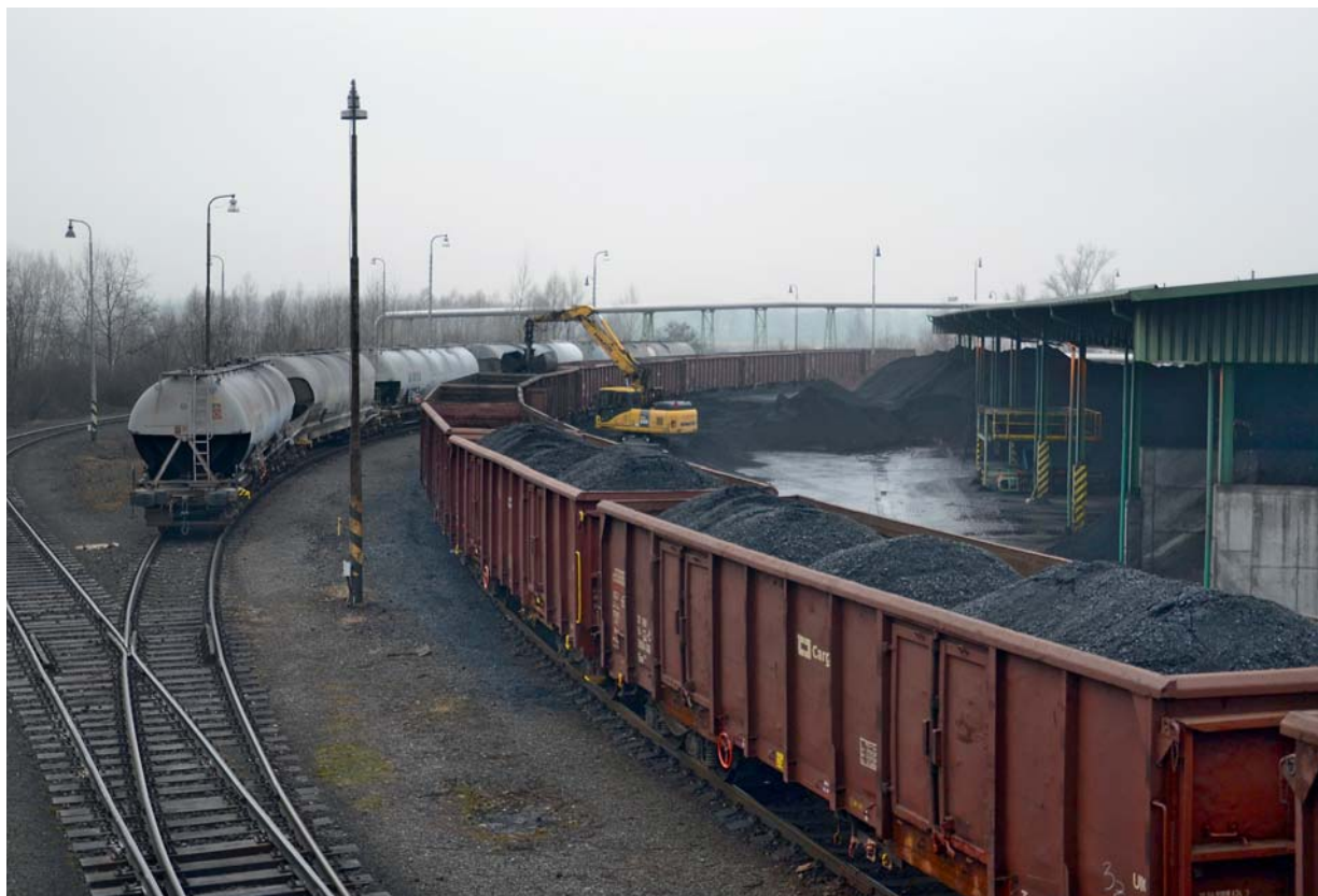
Vykládka uhlí z vysokostěnných vozů je prováděna drapákem.
