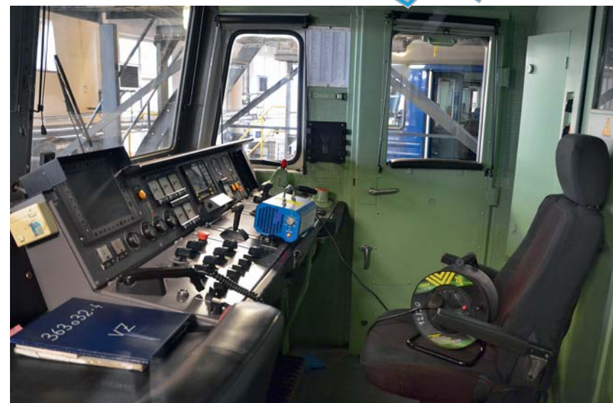
Z důvodu zamezení šíření viru Covid-19 je v SOKV Ostrava prováděna ozonizace stanovišť na lokomotivách. Samotné ozonování trvá přibližně 10 minut, poté je nutné stanoviště řádně vyvětrat. Provádí se i ruční dezinfekce stanovišť.
