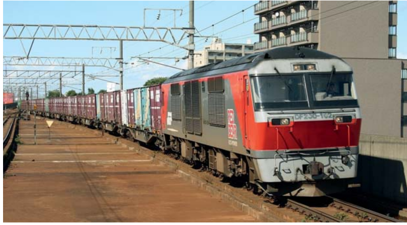
Na fotografii nákladního vlaku JR projíždějícího stanicí Chitose si na lokomotivě můžeme všimnout samočinného spřáhla. Foto: Tony Hurst, www.railpictures.net
