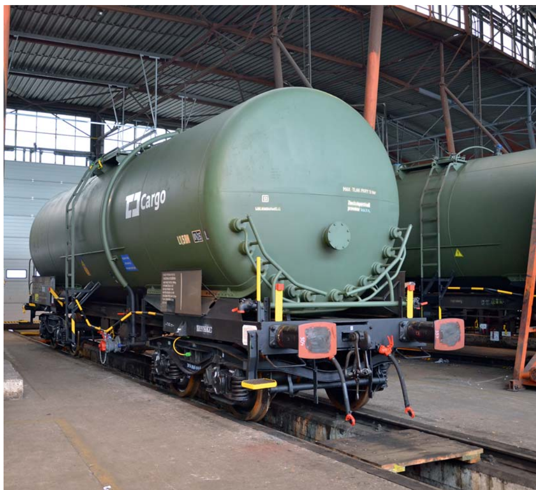
V OKV Most se cisternové vozy nejen opravují, ale je zde k dispozici i linka na tlakové a těsnostní zkoušky.
