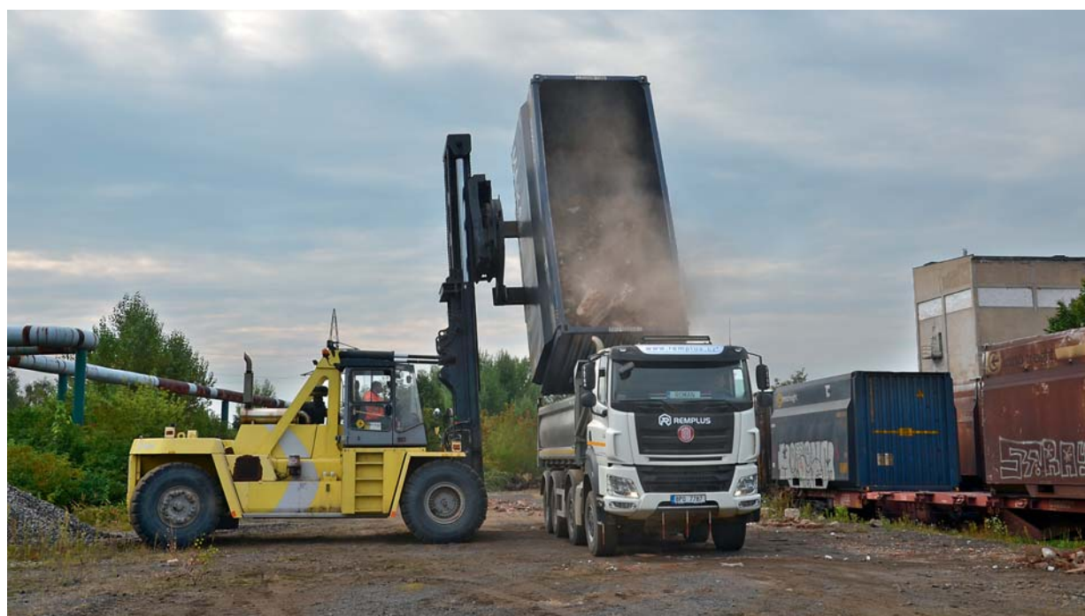
Jednoduchá vykládka odpadů z nástavb na nákladní automobily
