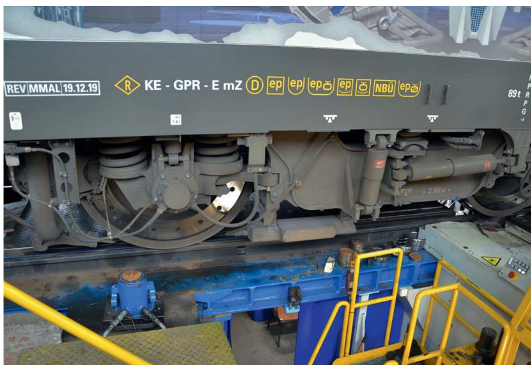
Lokomotiva řady 193 na podúrovňovém soustruhu
