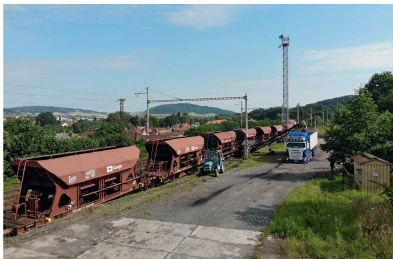
Vykládka uhlí z železničních vozů probíhá pomocí pásového dopravníku. Nákladním automobilem je pak odváženo do teplárny.
