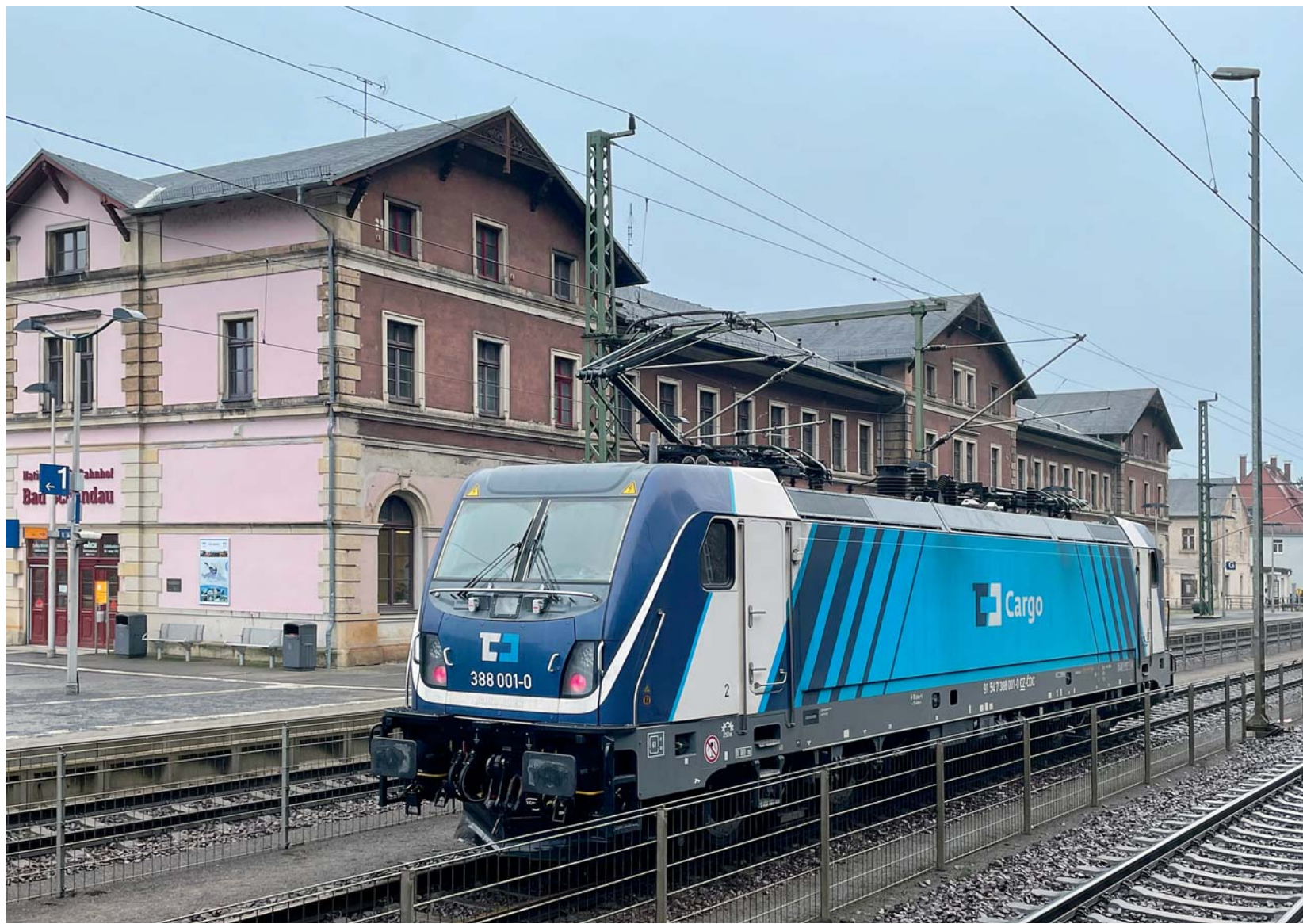
Dne 24. ledna 2022, tedy krátce po převzetí do stavu ČD Cargo, zavítala lokomotiva TRAXX 388.001 poprvé do německé pohraniční přechodové stanice Bad Schandau. Nejprve zkušebně „sólo“ z důvodu vyzkoušení přepínání při změně trakčních soustav a zabezpečovacího zařízení. Zanedlouho však dovezla do Bad Schandau i vlak s obilím. Jen o několik dnů později zavítal stroj 388.004 na Slovensko.
