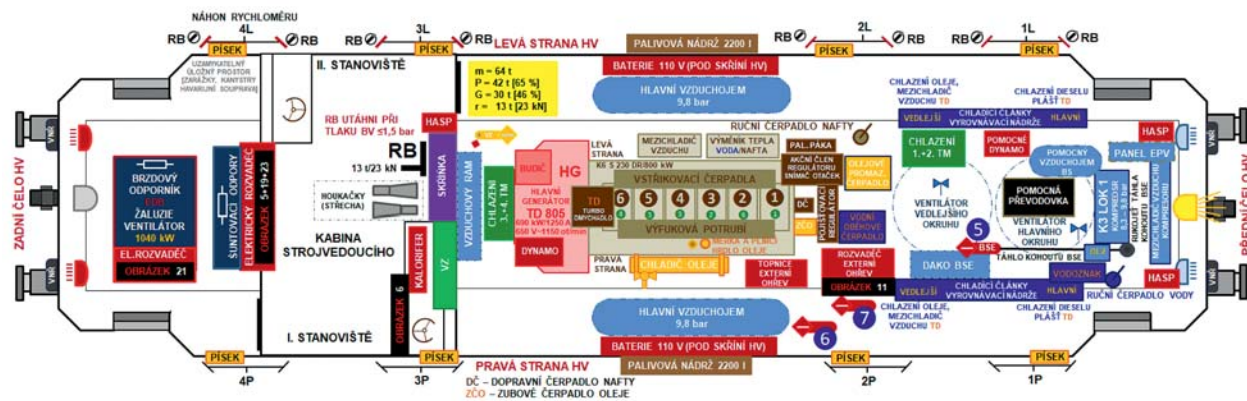
Ukázka půdorysu HV řady 743
