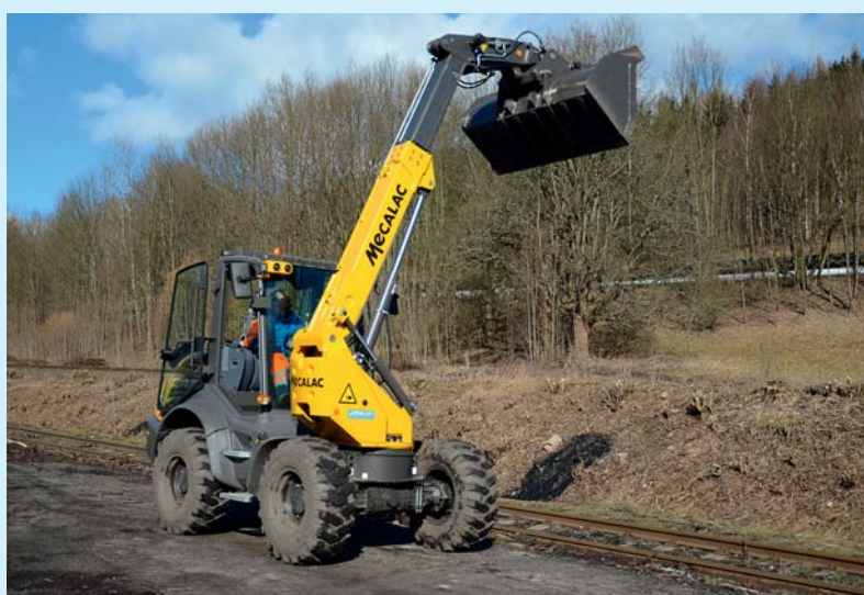
Velkou výhodou nakladače Mecalac je teleskopický výložník.
