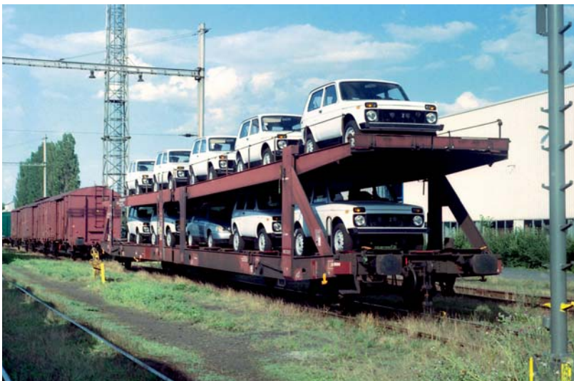
Vzácný příklad vozové zásilky nových automobilů ve 21. století. Nové vozy Lada směřující z Ruska k vykládce do Mělníka zachycené 12. července 2001 ve Všetech. I zde se prosadily patrové vozy a plošinové vozy řady Px se staly historií.
