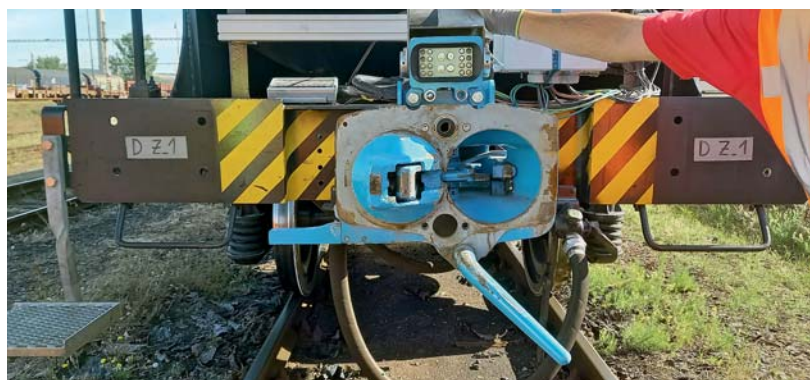
Automatické spřáhlo typu Voith
