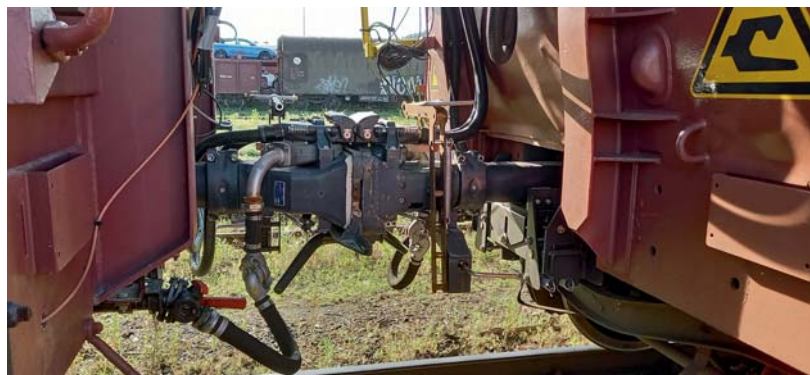
Automatické spřáhlo typu Dellner
