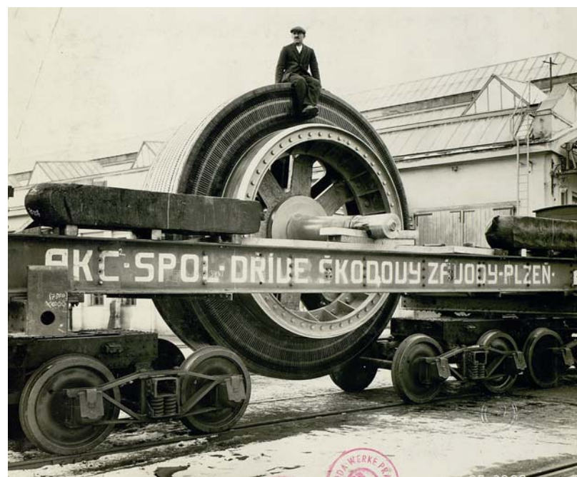
Rotor „těžného“ motoru byl v roce 1931 z Plzně do Dolu Alexandr přepravován samozřejmě po železnici.
