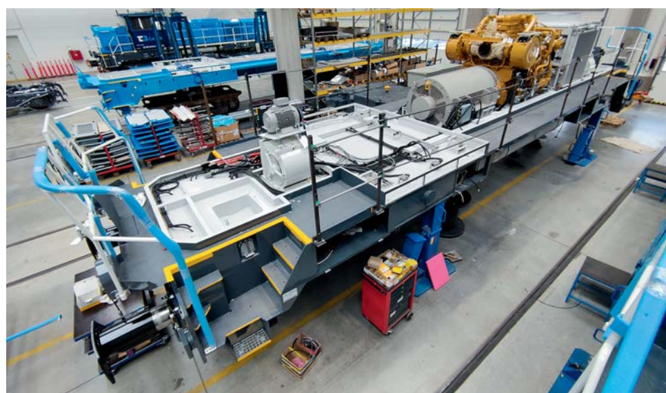
Montáž lokomotivy řady 742.71, konkrétně uložení motorgenerátoru společně s blokem chlazení spalovacího motoru, ve výrobním závodě společnosti CZ LOKO v Jihlavě. FOTO: DALIBOR PALKO
