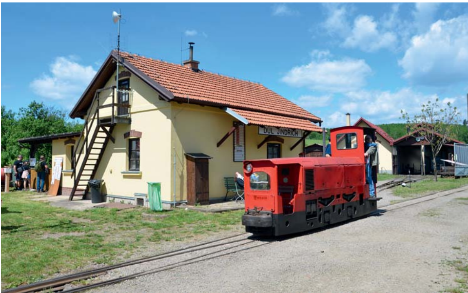
Původní důlní lokomotiva DH 70 D1 z roku 1980 byla v MPŽ rekonstruována do podoby povrchové lokomotivy a nyní je nasazována na vozbu osobních vlaků.
