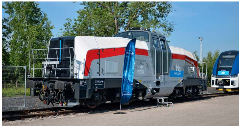
Zajímavou technickou novinku představovala posunovací lokomotiva PESA s vodíkovým pohonem.
