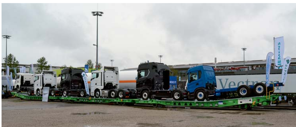
Tříčlankový vůz z produkce Tatravagónky pro přepravu nákladních vozidel pro firmu Hödlmayr
