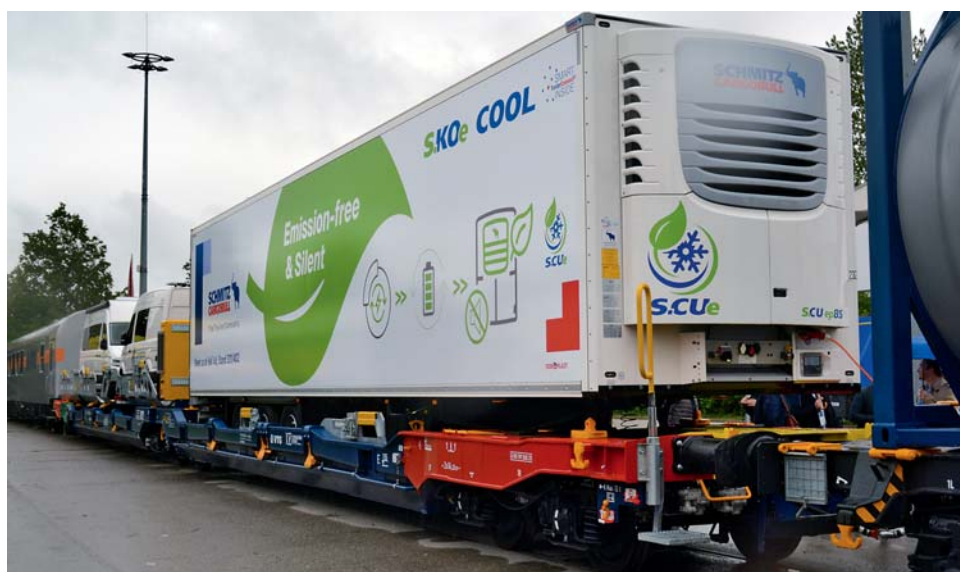
Košový vůz T4000 téhož výrobce pro zákazníka VTG. Tento vůz umožňuje jak přepravu návěsů, tak i menších silničních vozidel a též je schopen provozu na rozchodech 1 435 a 1 668 mm.
