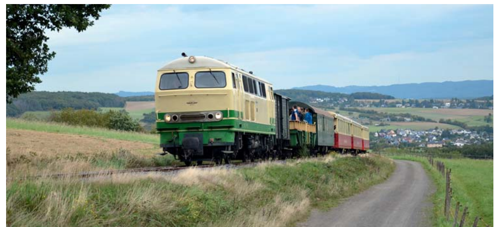
Také na tzv. Brohltalbahn, na úzkorozchodné trati (1 000 mm) z Brohl am Rhein do Engelnau byl až do roku 1934 částečně ozubnicový provoz (dvoulamelová Abtova ozubnice). Dnes zde jezdí nejen výletní vlaky Vulkan Express, ale trať je využívána rovněž pro nákladní dopravu.
