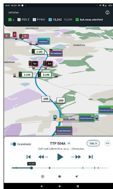
Zobrazení průběhu simulace jízdy vlaku. Význam barevného orámování: zeleně = informace byla přidána, červeně = informace byla odebrána, modře = informace byla změněna.
