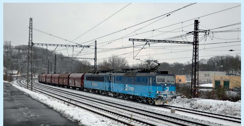
Dvojče „res“ 363.503 + 363.510 stoupá 4. prosince 2023 s loženou soupravou vlaku Pn 54378 do stanice Most. Na postrku 30vozové soupravy o hmotnosti 2 600 tun mu pomáhá lokomotiva 1.23.020.
