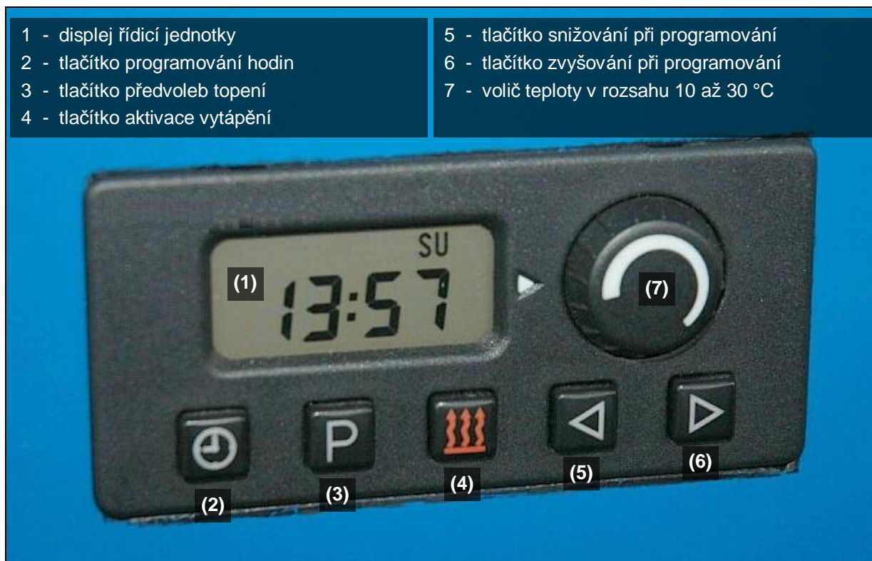
obr. 10: Ovladač teploty dušného topného agregátu (spínací hodiny)
