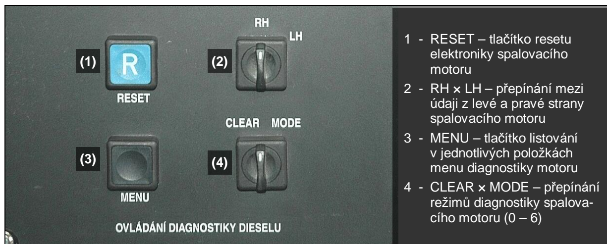
obr. 7: Ovladače diagnostiky spalovacího motoru
