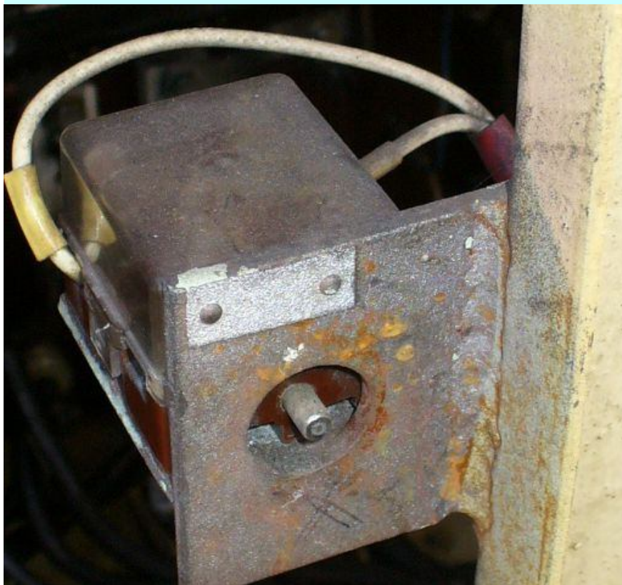
S 402 (10 kusů) + S 403 (8kusů) – koncové spínače kapot - uvedené počty jsou na celé lokomotivě
