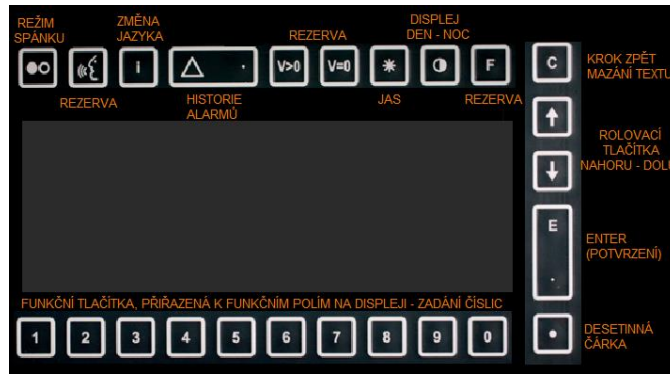
Obrázek: HWTL - Přehled a popis tlačítek základního ovládní displeje
