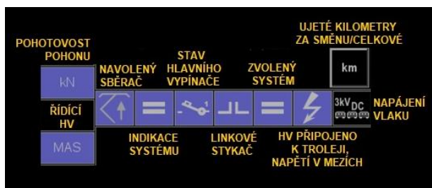
Obrázek: Obrazovka P1- stav Vn přístrojů v základním provozním stavu
