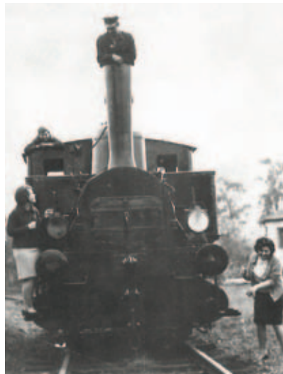
Lokomotiva 310.134 dostala v dílnách v České Lípě generální opravu v roce 1964. Tehdy působila na vlečce cukrovaru v Mnichově Hradišti. Do dopravy vlaků nikdy nezasáhla – neměla kompresor. Na snímku je vidět před kabinou strojvůdce tlumič výfuku parní brzd, kterou byla vystrojena. Fotografie vlevo zachytila i poněkud netradiční prohlídku komína (foto z archivu Zdeňka Hájka)
