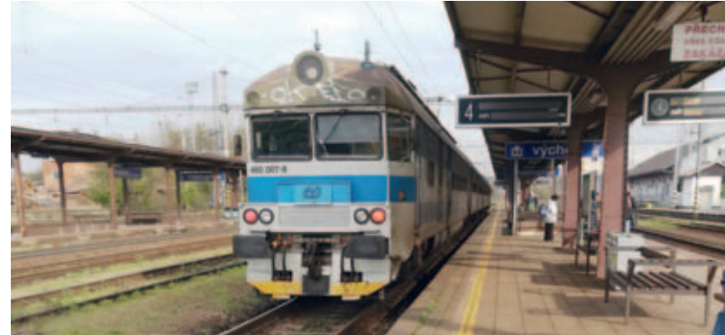
Na snímku z posledního říjnového dne loňského roku je elektrická jednotka 460 007-8 v žst Hranice na Moravě. Tyto jednotky, nesoucí původně označení jako řada EM488, byly určeny pro nasazení na tratích se stejnosměrnou trakcí, a sice v okolí velkých měst. V tomto případě je jednotka dislokována v DKV Olomouc, PJ Bohumín. Text a foto: Marek Poláček
