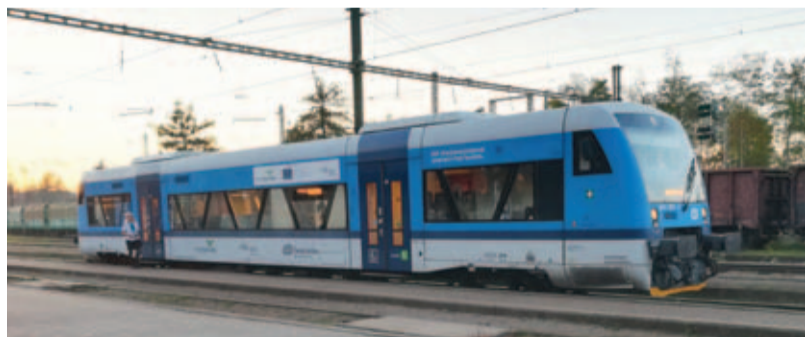
Ke zvýšení kultury cestování v kraji Vysočina přispěly České dráhy i nasazením motorových vozů ř. 841, u ČD pojmenovaných jako RegioSpider. Snímek 841 001-1 je ze žst Jihlava město. Právě tento MV dorazil do Havlíčkova Brodu jako první, a to 21. října 2011. Vozidla RegioShuttle RS1 vyráběná firmou Stadler Rail mohou být provozována rychlostí až 120 km/h. Text a foto: Marek Poláček
