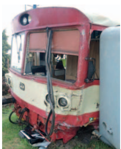
Následky střetu motorového vozu řady 810 s nákladním automobilem na železničním přejezdu P7140 ve Velkých Pavlovicích (foto Drážní inspekce z 25. května 2015)
