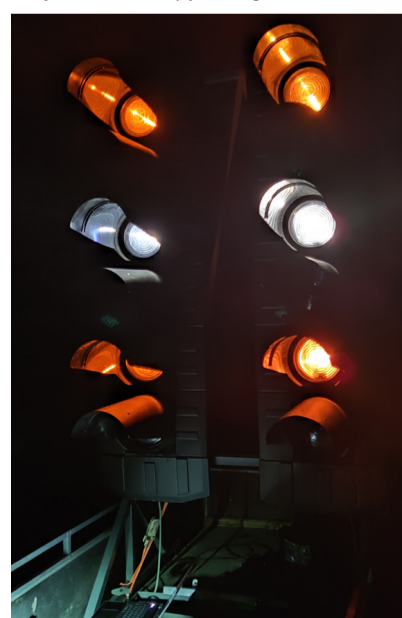
Porovnání „vnitřnosti“ klasického žárovkového světla a LED. Na druhém snímku pohled na provizorní zkušební platformu návěstidel. Vlevo LED, vpravo klasické žárovky. Foto: David Votrúbek
