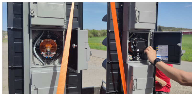
Porovnání „vnitřnosti“ klasického žárovkového světla a LED. Na druhém snímku pohled na provizorní zkušební platformu návěstidel. Vlevo LED, vpravo klasické žárovky. Foto: David Votrúbek
