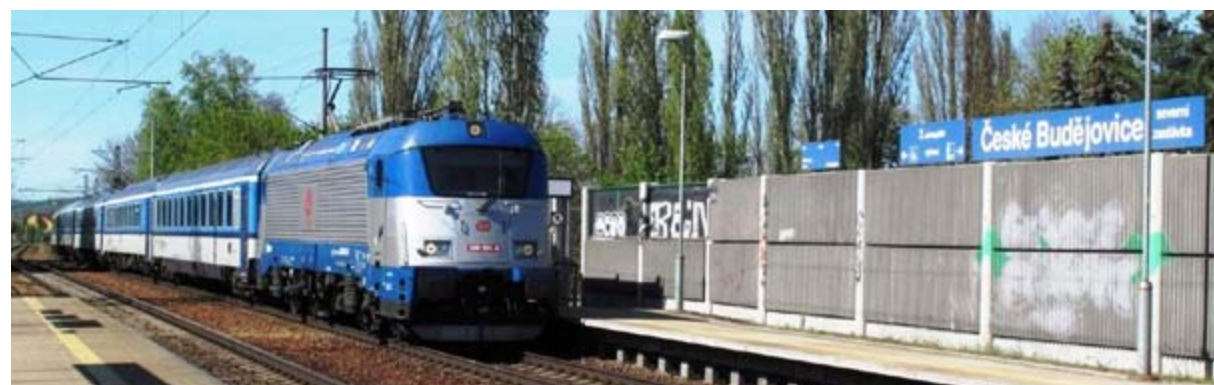
Trísystémová lokomotiva 380 001-8 projíždí v čele vlaku Jižní expres EC 335 z Prahy do Linze. Na této trase stroj využívá všechny tři napájecí systémy v pořadí od stejnosměrné přes střídavou 25 kV/50Hz až po rakouskou 15kV/16.7Hz. Snímek byl pořízen 9. května tohoto roku při příjezdu zastávkou České Budějovice severní zastávka. Text a foto: Jan Kubeš
