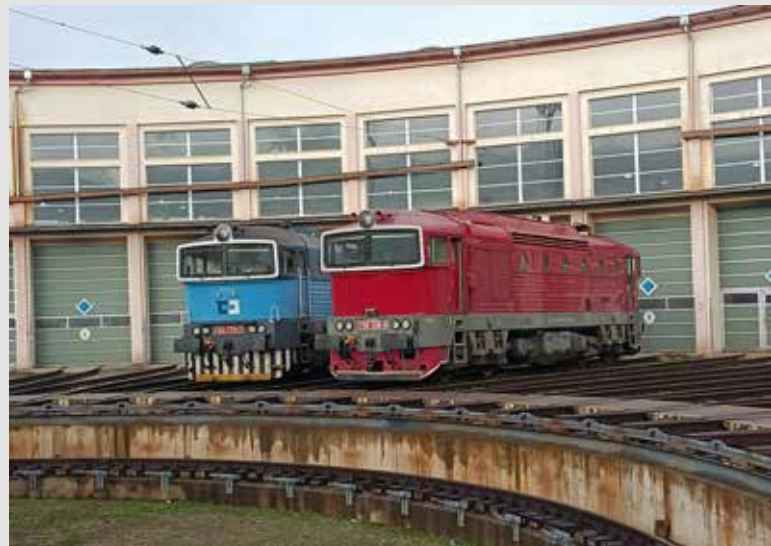
Dvě lokomotivy s přezdívkou brejlovec před ústeckou rotundou. Navenek jsou vzhledově stejné, ale co se týče pohonu spalovacího motoru tak je každá jiná. Zatímco 753 770 prošla modernizací dosazením motoru Caterpillar její kolegyni 750 338 pohání původní motor ČKD K 12V 230 DR.
