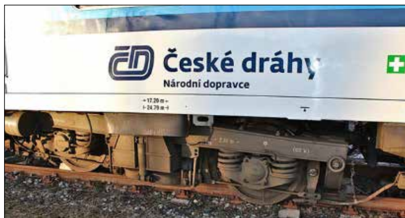
Vykolejená druhá náprava prvního povozku HDV vlaku Sp 1834.
