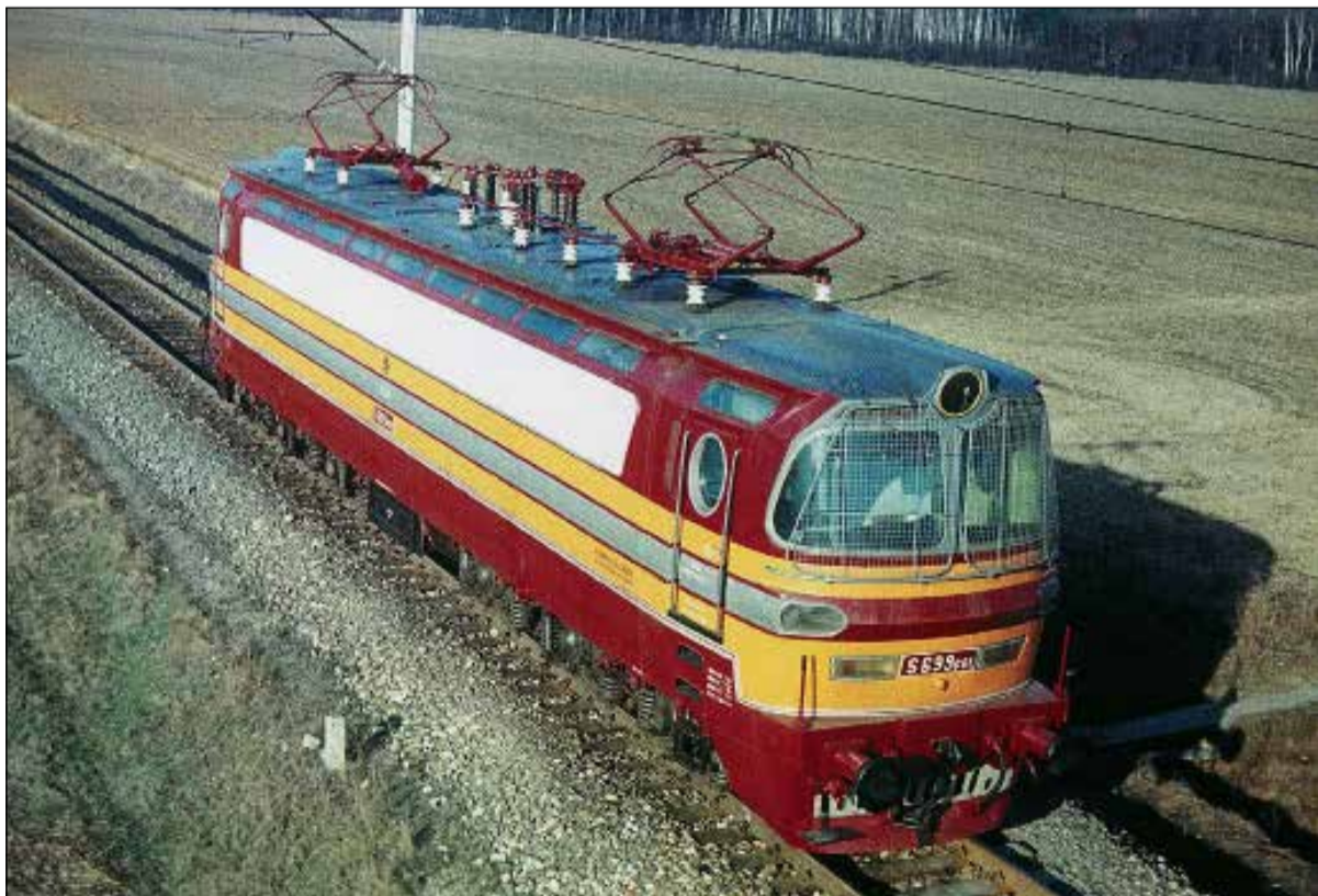
Z důvodu bezpečnosti při vysokých rychlostech byla před čelními okny připevněna ochranná síť. Lokomotiva při jízdě na okruhu v Cerhenicích.
